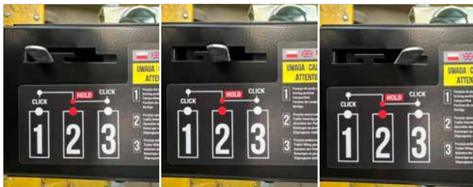
Zahngetriebe: POSITION 1 - Fahren / Absenken, POSITION 2 - Heben
