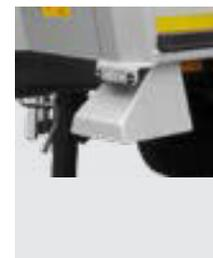
Dank der Stufen am vorderen Teil des Anhängers, wird das Betreten der Kastenmulde erleichtert.
