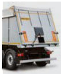
Ein **Balken** oder eine Kette verbindet die Seitenwände und stärkt den Aufbau der Kastenmulde.
