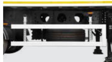
**Das Ersatzrad** im Korb vor der ersten Achse kann für eine verbesserte Bedienung optional mit einer manuellen Winde ausgestattet werden.
