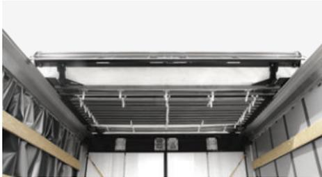
Stirnwandverstärkung mit 1.500 mm Höhe aus Plywood oder Stahlblech zum Schutz gegen Beschädigungen.
