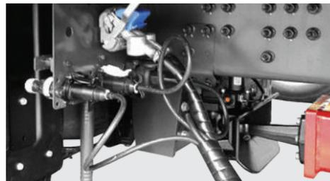
Luftfederung, Ventil für Heben und Senken.
