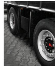
Der Zentralachs-Anhänger sowie das LKW-Fahrgestell können mit einer Liftachse ausgestattet werden, die den Wendekreis verkleinert und das Anfahren bei schlechten Witterungsverhältnissen erleichtert.
