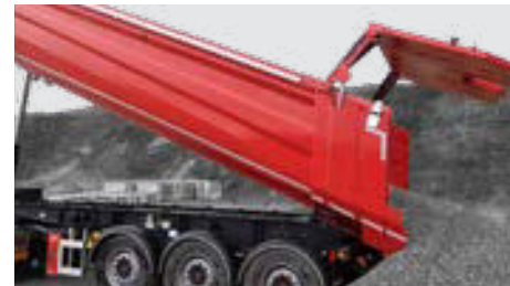
Verstellbarer Öffnungswinkel der Klappe.
