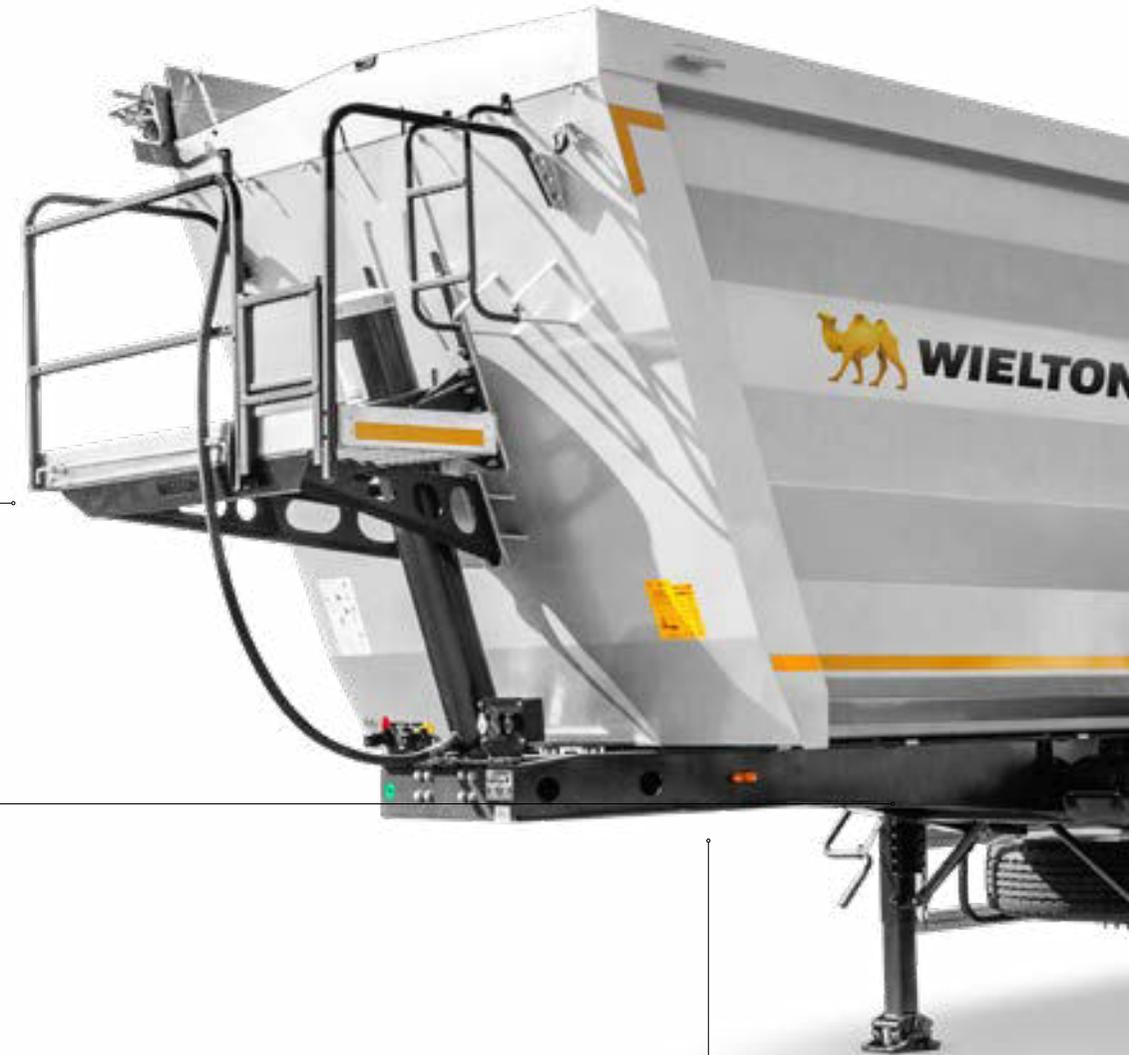
Die quer liegenden Streben garantieren die Stabilität der Seitenwände bei langer Nutzung.
