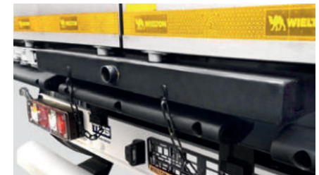
Diebstahlschutzleiste zum Schutz der Riegel
