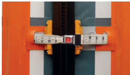
Zwischenlagen an den Seitenpfosten im XLS-System
