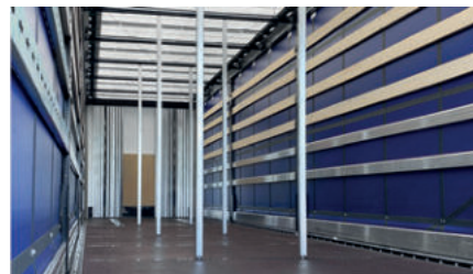
Vertikale Pfosten in Verstauen Position
