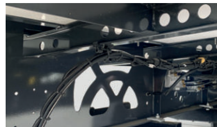
Gewichtsoptimierte Heckkonstruktion des Aufliegers
