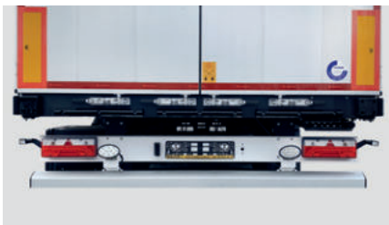
Aluminium-Unterfahrschutz zur Gewichtsreduzierung
