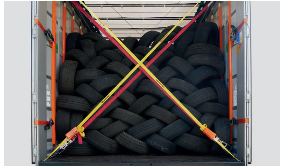
Konfiguration der Einstecklatten für den Reifentransport
