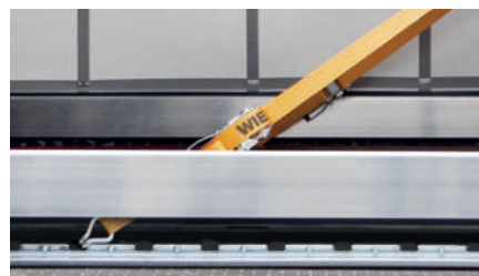
Sockelprofil mit Safety-Lock-Leiste
