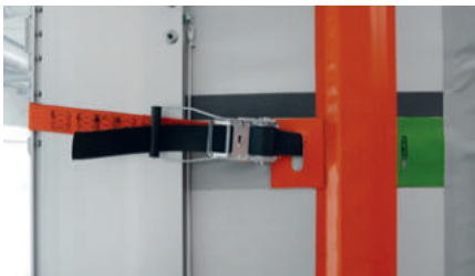
Planenspannung im XLS-System
