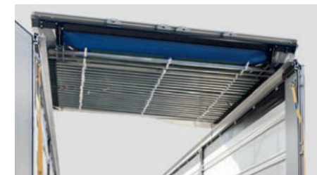
Schiebeverdeck zum einfachen Beladen
