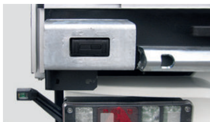
Rückwärtsfahrsensor im hinteren Rampenpuffer
