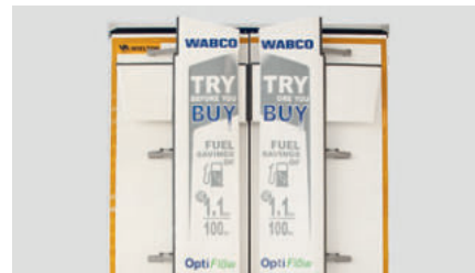
Gefaltete aerodynamische Abdeckungen
