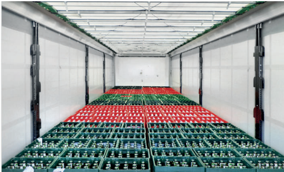
Leiste zur Sicherung der transportierten Getränke
