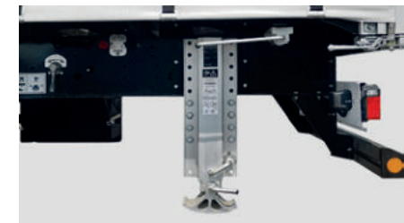
Stützfüße zur Sicherung der Last
