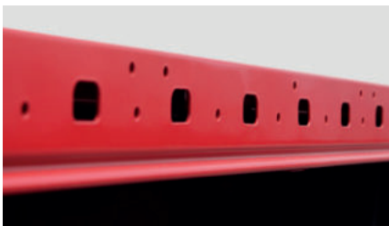
Ladungshalteösen im Rahmenflansch
