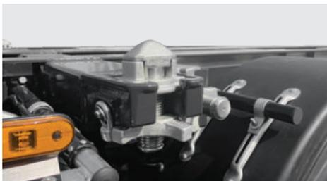
Die Containerverriegelungen ermöglichen verschiedene Arten von Container zu befestigen.
