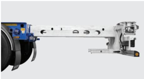
Mechanischer oder pneumatischer Heckausschub, angepasst zum Transport aller Container-Arten.
