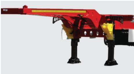
Leichter Seitenanfahrtschutz aus Verbundstoff. Leichter Zugang zum Werkzeugkasten.
