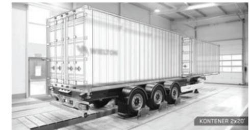
Optionale Ausstattung aus Aluminium: Sattelstützen, Luftbehälter, Felgen – Eigengewichtsreduzierung um bis zu 210 kg.
