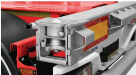
An Verladerrampen angepasster Unterfahrschutz- und Leuchtenschutz.
