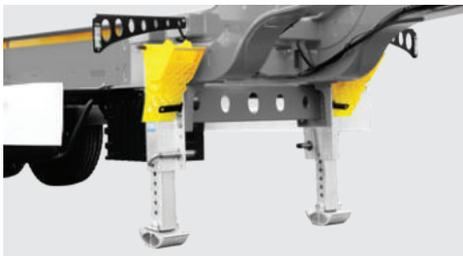
Sattelstützen aus Stahl bzw. Aluminium.
