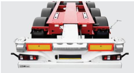
Heckausschub mit PTFE-Platten und Rollen. Mechanische oder optional pneumatische Bedienung für schnelleres Umstellen.
