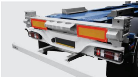
Das Heck des Aufliegers ist mit Stahlpuffern, Unterfahrerschutz aus Stahl bzw. Aluminium und universellen höhenverstellbaren Verriegelungen ausgestattet.
