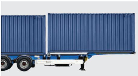
Die Befestigung des ersten 20' Containers am vorderen Holm - ermöglicht die Entladung direkt von der Frontseite des Fahrzeugs.
