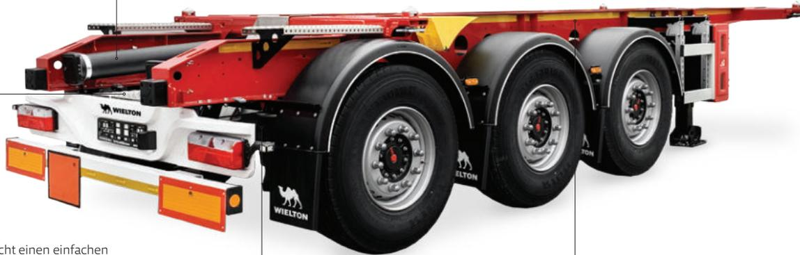
Die Plattform ermöglicht einen einfachen Zugang zum Auflieger um den Behälter zu bedienen und ist rutschfest. Eine Sammelkammer verhindert das Überschwappen auf die Fahrbahn.
