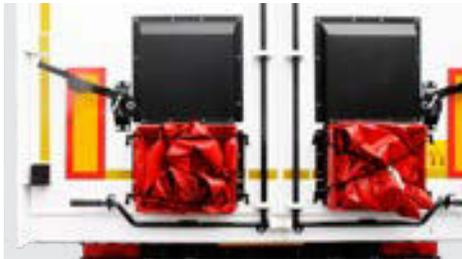
Die universelle **Klappentür** hat zwei Öffnungen zum Schütten, die über Haken mit zusätzlichen Spannratschen verriegelt werden. Ein Balken an der Klapptür erleichtert das Beladen im hinteren Teil des Aufliegers
