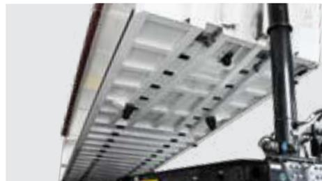
Die gewichtsoptimierte Arbeitsplattform mit Klappleiter ist dank der Befestigung am Ladekasten sehr stabil und sorgt für höchste Sicherheit beim Öffnen und Schließen der Plane.
