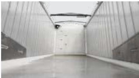
Die Länge und Breite des Ladekastens ermöglichen den Transport von bis zu 26 Paletten. Optional ist eine abgerundete Kastenmulde, um Materialrückstände in Ecken und Kanten zu verhindern.
