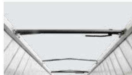
**Balken**, die die Seitenwände verbinden, sind standardmäßig im Bulk Master verbaut und garantieren die Stabilität des Rahmens und der Seitenwände.
