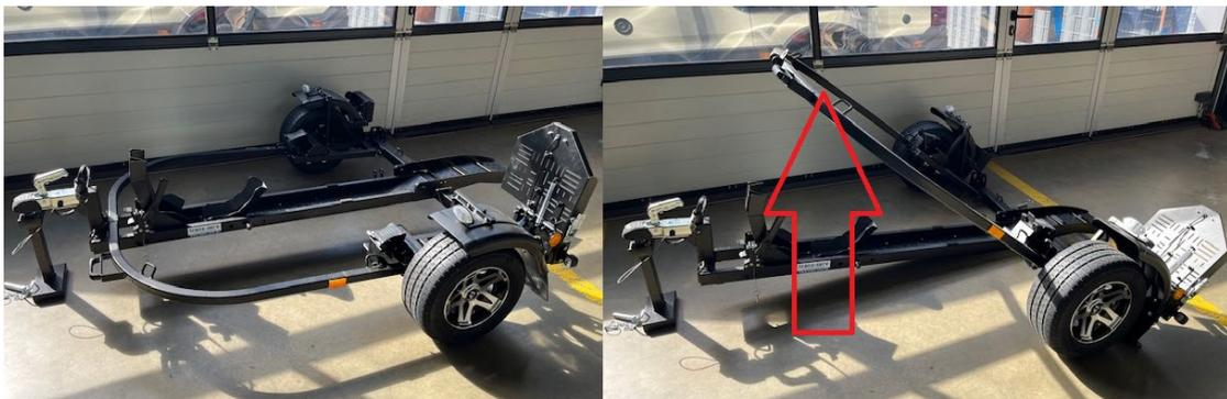
4. Mit dem Motorrad über den Hauptrahmen in den Radstopper einfahren.
