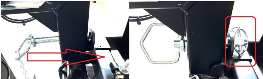
**Achtung, Bügelrahmen stets festhalten. Durch das Gewicht des Motorrades senkt sich der Anhänger selbständig ab sobald die Sicherung entriegelt wird!
