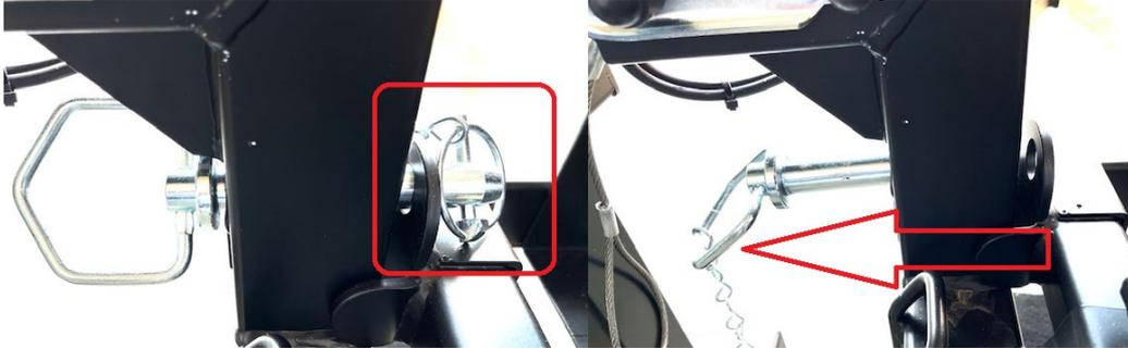
2. Bügelrahmen fest halten und manuellen Sicherungshebel entriegeln und nach oben ziehen.
